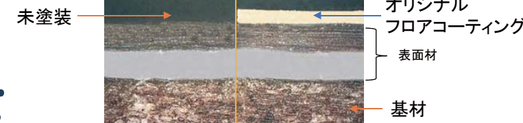
※マイクロスコープによるフローリング断面画像
